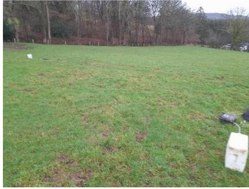
Le pied de sonde est posé à 1m sous le niveau naturel du terrain. Les tests se sont déroulés sans soucis apparent. Les résultats donnent les courbes de saturation du sol. La nappe n'est pas visible à la profondeur de 1m.
